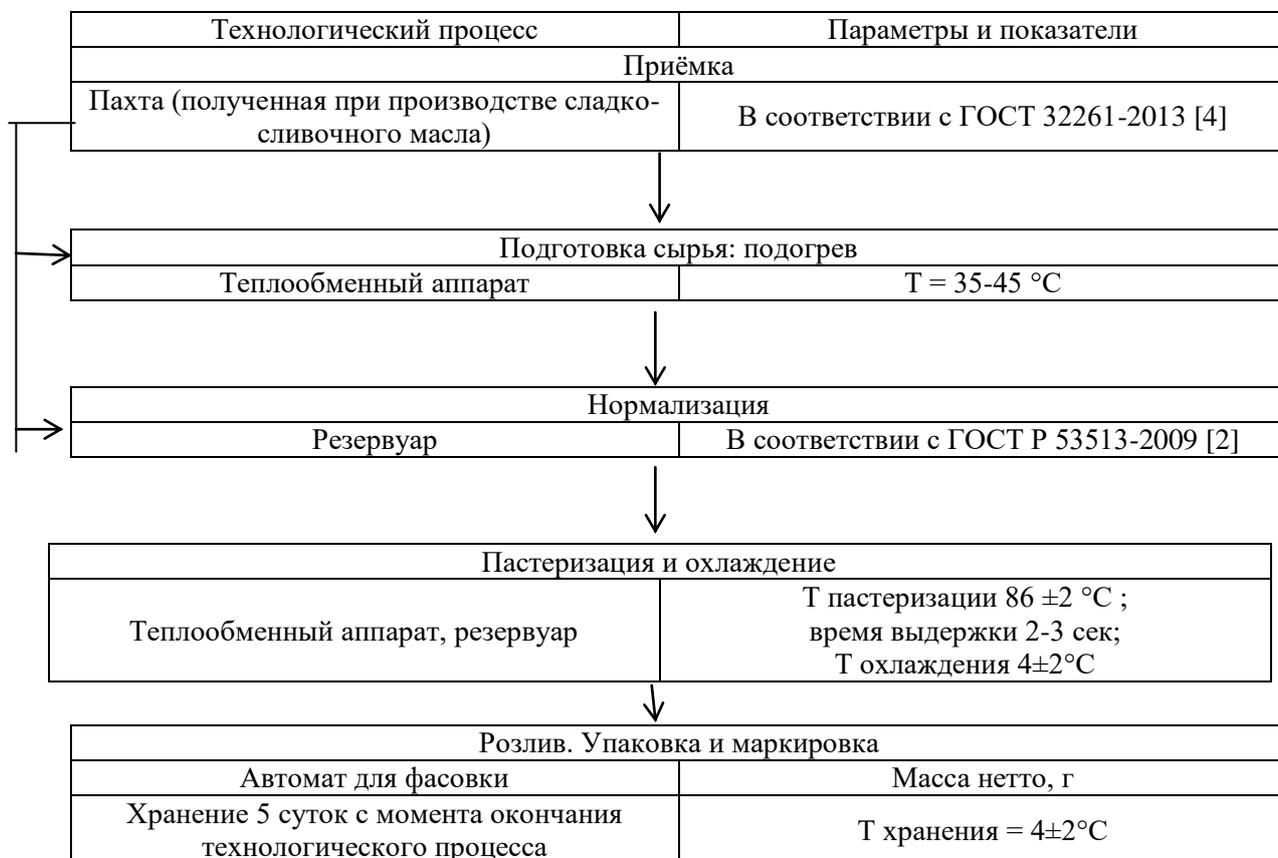
Рисунок 2 - Технологическая схема производства пахты пастеризованной
