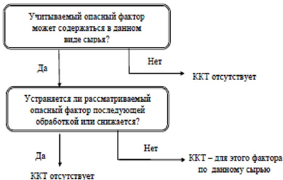
Рисунок 1 - Алгоритм выбора ККТ по технологическим операциям производства продукта
